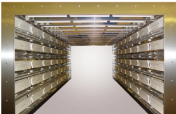
▲ 長波陶長波陶瓷隧道爐 61kW 2100 x 1000 x 752 mm
