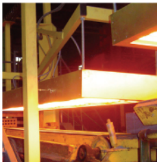
▲ 1. 聚焦式加熱系統 7.8KW 面積3050 x 150mm. 2. 聚焦加熱系統 3. 短波加熱系統 53.6kw 面積 Ø750 x 300 mm 4. 快速中波加熱系統 36kW 面積 2000 x 500
