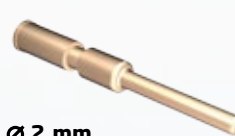
Ø 2 mm Crimpbereich 0,35 - 2,5 mm 2 crimping range 0.35 - 2.5 mm 2 61.242.11
