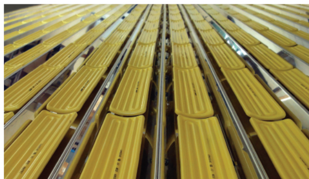
▲ 1. 聚焦式加熱系統 7.8KW 面積3050 x 150mm. 2. 聚焦加熱系統 3. 短波加熱系統 53.6kw 面積 Ø750 x 300 mm 4. 快速中波加熱系統 36kW 面積 2000 x 500
